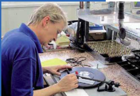
Mit großer Sorgfalt erfolgt die Justage der Tonabnehmer in die Komplett dreher (o.), die Pro-Ject in allen Preisklassen führt. Wahnsinn: Die winzigen Pins der Tonarmminnenverkabelungen (r.) wurden Stück für Stück manuell angelötet
