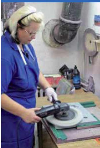
Klebstoff in Füße spritzen, lackierte Chassis polieren oder Kleinteile verarbeiten (v.o.n.u.) – auf den Etagen der Plattenspielerfabrik herrscht eifrig Betriebsamkeit
