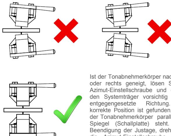
Ist der Tonabnehmerkörper nach links oder rechts geneigt, lösen Sie die Azimut-Einstellschraube und drehen den Systemträger vorsichtig in die entgegengesetzte Richtung. Die korrekte Position ist gefunden, wenn der Tonabnehmerkörper parallel zum Spiegel (Schallplatte) steht. Nach Beendigung der Justage, drehen Sie die Azimut-Einstellschraube wieder fest.
