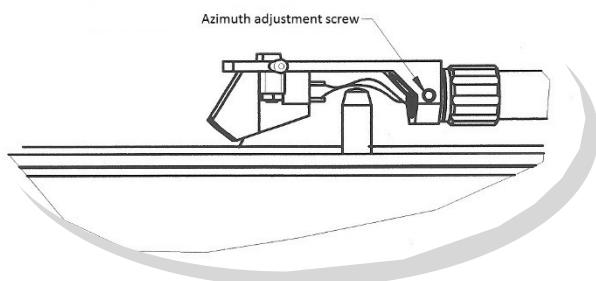
Die korrekte Einstellung des Azimut hilft mit die Wiedergabe-Qualität zu maximieren. Mit Hilfe des Spiegels der Einstellschablone „Align it“ kann die korrekte Position schnell ermittelt werden - siehe nachfolgende Bilder:
