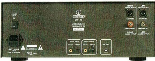
Die gut bestückte Rückseite bietet viel Platz für die optischen und koaxialen Ein- und Ausgänge, sowie den USB-Eingang. Es besteht die Wahl zwischen symmetrischen XLR und RCA Ausgängen. Links befinden sich Netzanschluss und Netzschalter
